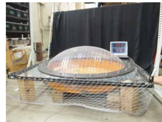
横浜国立大学での引張剛性測定試験
